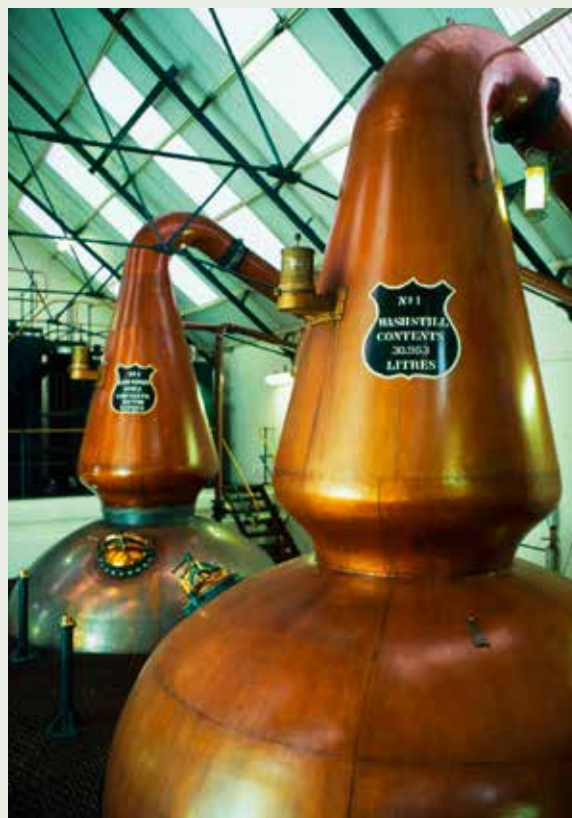
Die kupfernen Brennblasen sind das Herz einer jeden Brennerei. Dabei gibt es unterschiedliche Größen und Formen. Eines ist immer gleich, das Material ist Kupfer.
