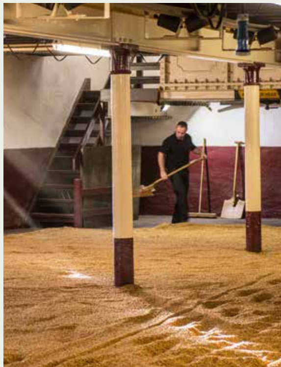
In wenigen Brennereien wird heute noch ein Teil des Malzes selbst hergestellt. Hier in „Floor Maltings“ – auf Deutsch in einer Tennenmälzerei.
